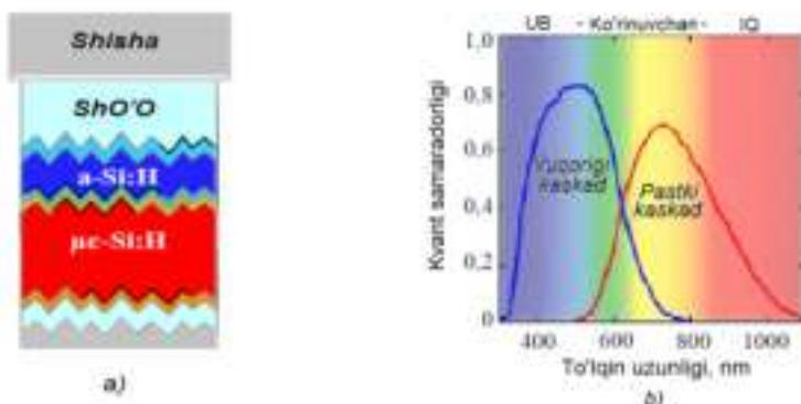
Rasm. a-Si:H/mk-Si:H tandem strukturining (a) va uni spektral xarakteristikasining (b) sxematik tasviri (ShO'O - shaffof o'tkazuvchan oksid qatlam)
